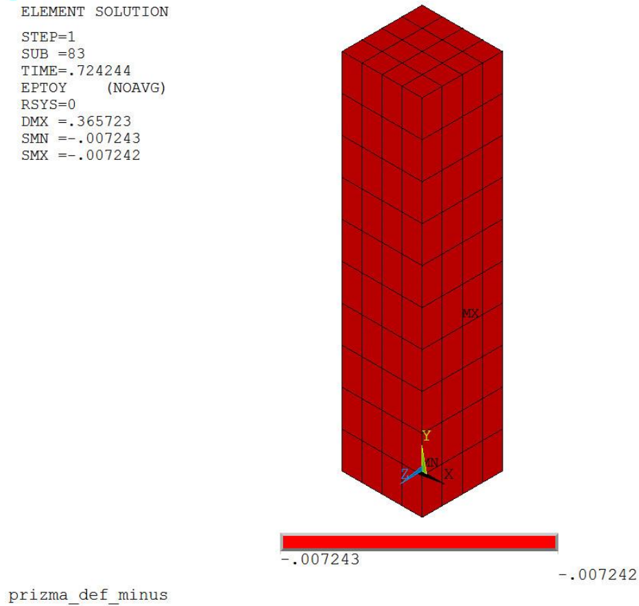
Рисунок П.3 – Относительные вертикальные деформации бетона призмы на последнем шаге нагружения соответствуют предельной величине, заданной в расчетной модели – 2 \times 0,0035
